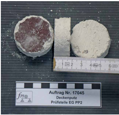
Abb. 10: Dokumentation des Putzaufbaus
