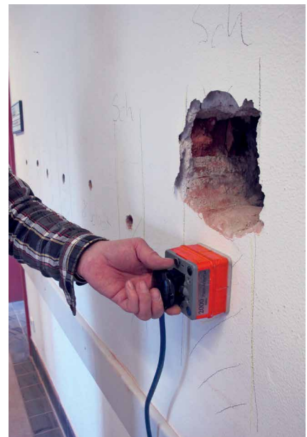
Abb. 12: Kalibrierungsöffnung zum Radargramm in Abb. 11
