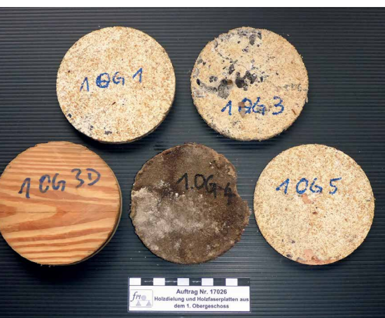
Abb. 7: Aus den Bohrkernen der Geschossdecken herausgearbeitete Holzbohrkerne zur Rohdichtebestimmung
