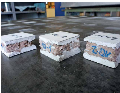
Abb. 17: Abgleichen der Lagerfugenmörtelproben
