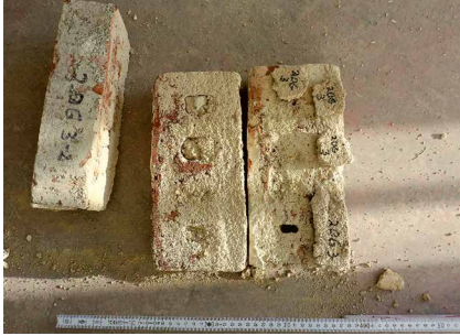
Abb. 14: Entnommene Mauerziegel und Lagerfugenmörtelproben
