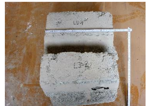
Entnahme großformatiger Betonsteine
